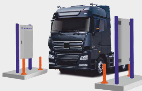
Вариант транспортного монитора в составе: БДРМ-05 (4 шт.), БДКН-05 (4 шт)
