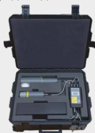
Измеритель гамма- и нейтронного излучения: БДКГ-11М (1 шт.), БДКГ-04 (1 шт.), БДКН-05 (1 шт.)
