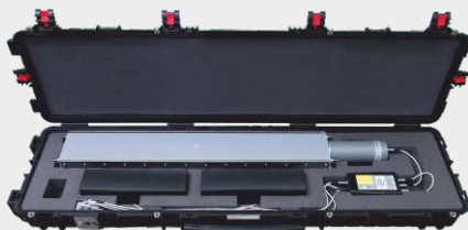
Измеритель высокочувствительный счетный гамма- и нейтронного излучения: БДРМ-05 (1 шт.), БДКН-05 (2 шт.)
