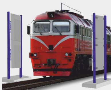
Вариант транспортного монитора в составе: БДРМ-05 (8 шт.), БДКН-05 (8 шт)
