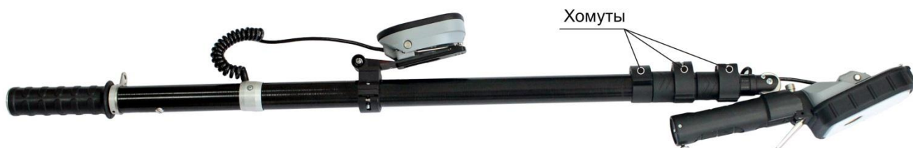
Рисунок 2.3 – Соединение БС с БОИ штангой
