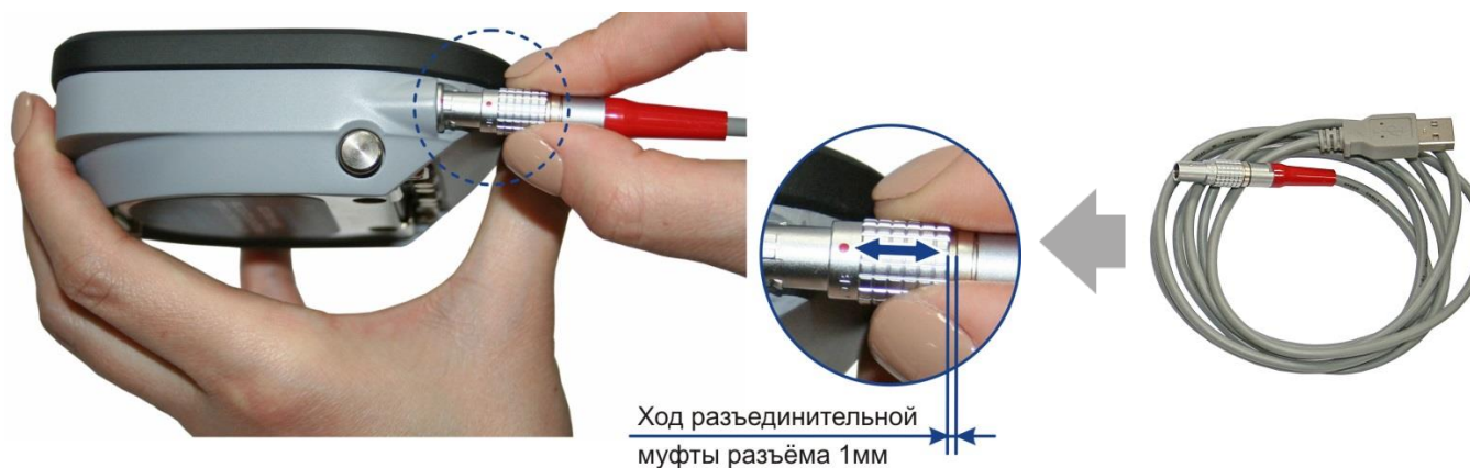
Рисунок 2.16 – Подсоединение прибора к внешнему источнику питания
